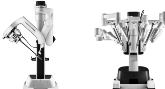
Slika...6. Da Vinci. Da Vinci je robot hirurg koji se koristi za izvođenje “minimalno invazivnih operacija” (Intuitive.com).
