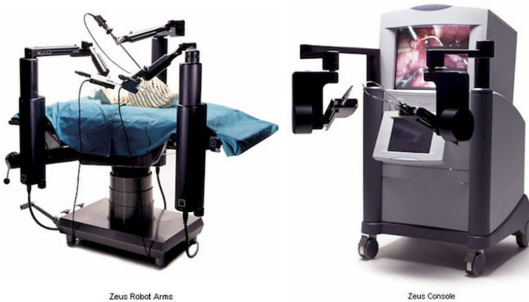
Slika .5. .Zeus Robotic systems. Robot korišten u prvoj Transatlantskoj operaciji 2001. Godine (Winata, 2018)
